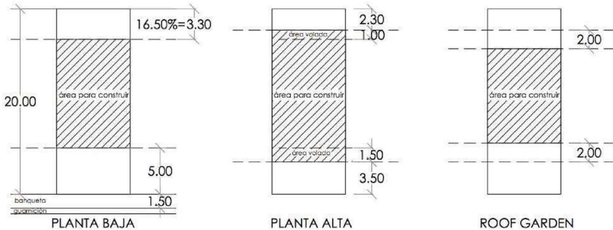
**NOTA:** Los lotes con una longitud menor a 18.00m serán sometidos a una revisión especial de restricciones: Se deberá respetar el 16.5% de la longitud del terreno para la restricción posterior. Así como los 5.00m de restricción al frente en los dos cajones de estacionamiento, pero si se desea, es posible utilizar área sobrante del frente, dejando libre hasta 3.50m como mínimo, esto con previo análisis y autorización del Comité Técnico.
