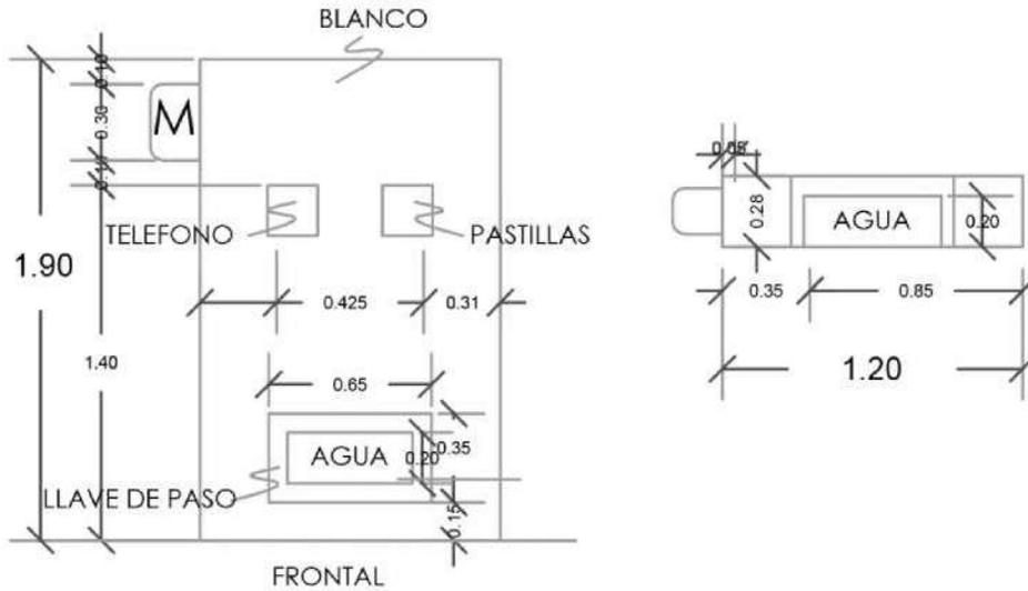
EL TUBO DEBERÁ SER DE COBRE ABARCANDO LOS 65 CM. DEL MURETE CONSIDERAR EL ESPACIO LIBRE PARA EL MEDIDOR Y ACCESORIOS
